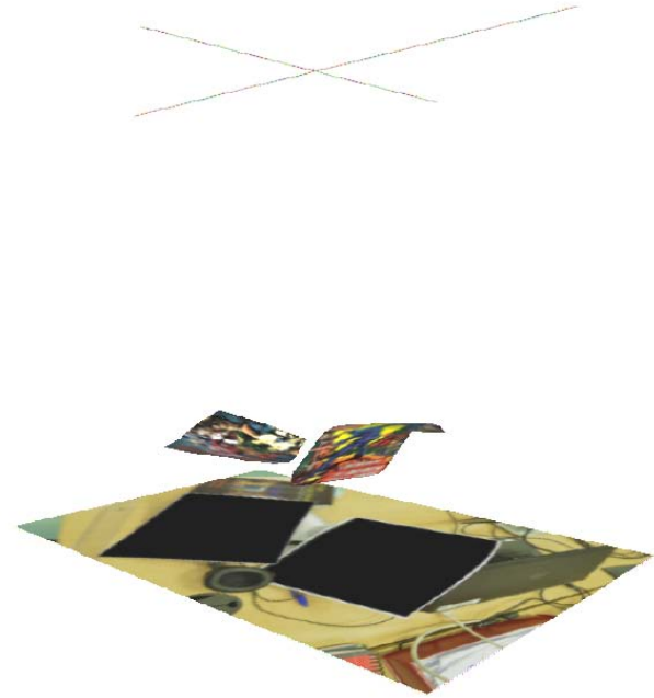
Figure 12: Reconstruction 3D par SFT des deux objets détectés par l'indexation, selon deux points de vue. Temps total de reconstruction \approx 4s .
