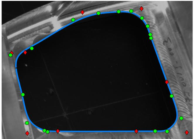
Fig. 4. EVOLUTION OF THE CONTROL POINTS. THE FIGURE SHOWS THE 10 INITIAL CONTROL POINTS (DIAMONDS), THE 18 CONTROL POINTS AFTER OPTIMIZATION (CIRCLES) AND THE FINAL CURVE.
